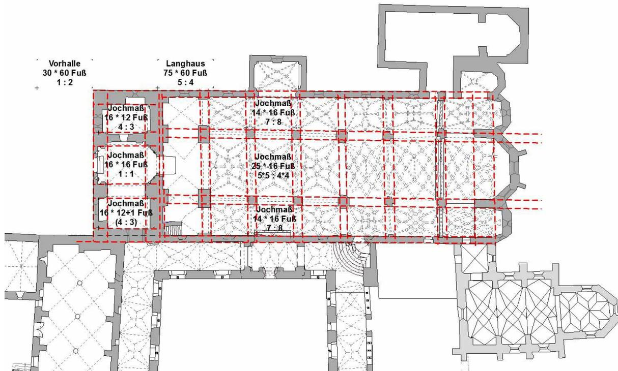
Abb. 14: Verformungsgerechtes Aufmaß der ehemaligen Stiftskirche in Millstatt mit Eintragung der Mauerfluchten und der Baumaße der Vorhalle und des Kirchenraums nach Umrechnung auf ein Fußmaß von 31,1 cm.
