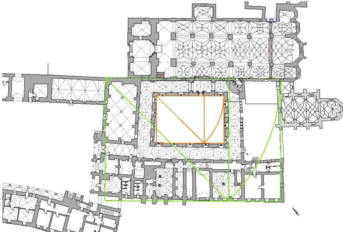
Abb. 13: Verformungsgerechtes Aufmaß des Klosters Millstatt: Nachweis der Absteckung des Klausurrechtecks (grün) und des Klosterhofs (braun) als Kreisabschläge der Basislänge eines gegebenen Rechtecks auf die Diagonale eines Quadrats.
